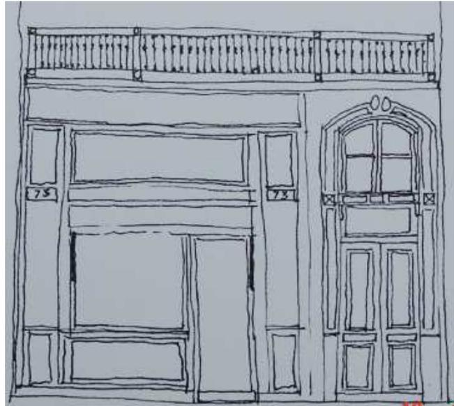
« Au XIXème siècle les poteaux fontes permettent la reprise des charges des élévations, les façades des rez-de-chaussée sont alors en bois posées en applique, en légère saillie par rapport à la façade. On peut alors disposer de grands vitrages formant vitrines. »
