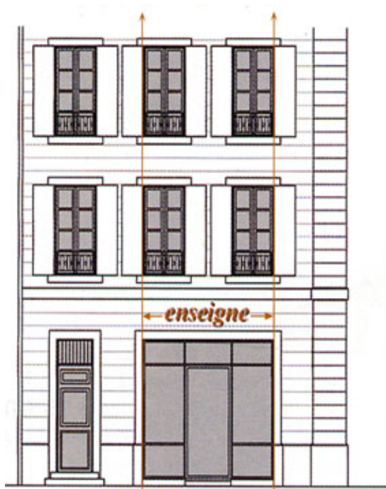
Principe d'intégration de l'enseigne dans le tracé régulateur d'une façade
